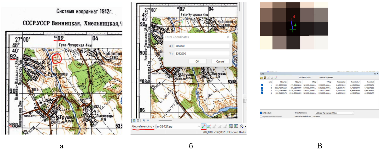
Рис. 4.6 Визначення прямокутних координат для перетину ліній кілометрової сітки (обведено червоним) – X=5502000, Y=5392000
