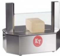
напівавтоматична струнна сирорізка. На нарізку шматка витрачається 1-2 сек.
