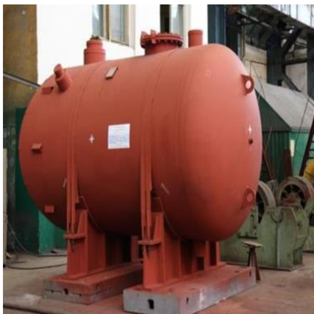
Рис. 1. Загальний вид деаератора ДСП-500
