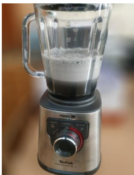
Рис. 3.8. Схематичне зображення виробництва графену в кухонному блендері з використанням водного розчину ПВП
