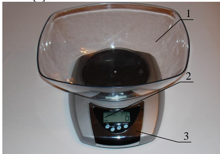
Рис. 1. Електронна вага VINZER: 1 – чаша для зважування; 2 – шкала; 3 – платформа для зважування
