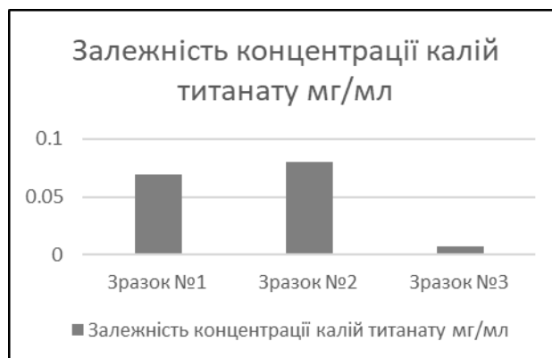
Рис. 1. Залежність концентрації синтезованого \text{K}_2\text{TiO}_3 від співвідношення компонентів.
