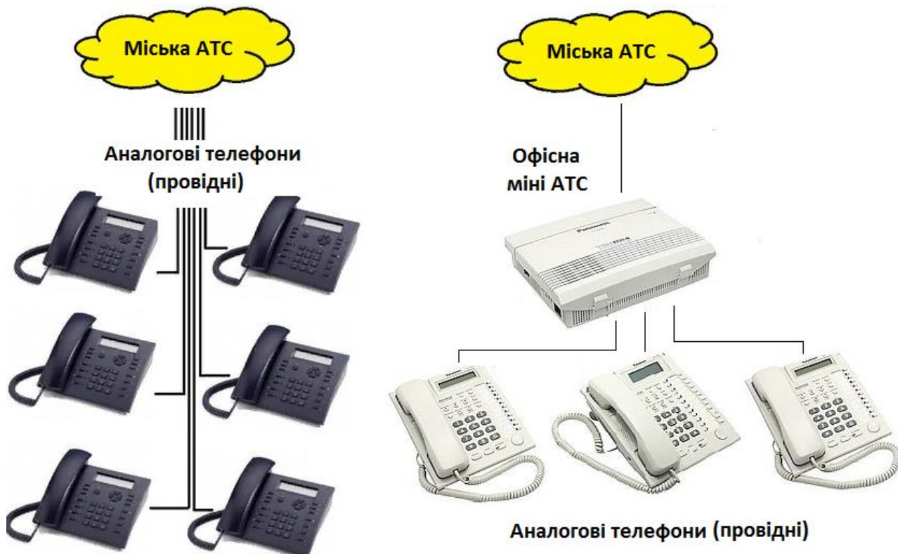
Рис. 1. Підключення офісних аналогових телефонів до міської АТС: а) безпосередньо, б) через офісну міні АТС.
