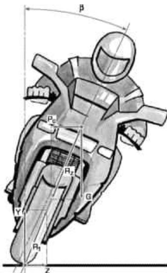
Рисунок 1 – Сили, що діють на мотоцикл при повороті:
