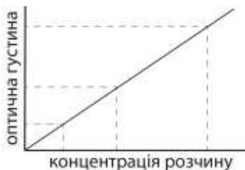
Рис. 9. Залежність оптичної густини від концентрації розчину
