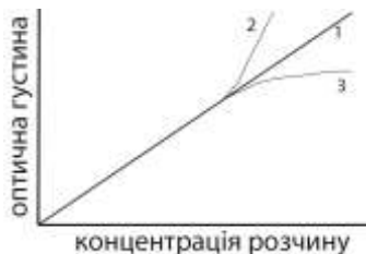
Рис. 10. Відхилення від основного закону світлопоглинання (1); 2 – позитивні, 3 – негативні
