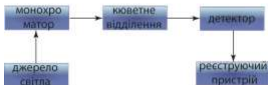
Рис.12. Принципова схема приладу для вимірювання оптичної густини розчинів
