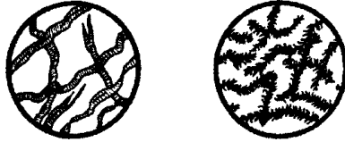
Рис.1.15 – Волокна паперу до (зліва) і після (справа) фібриляції
