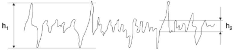
Рисунок 1.20 – Мікрогеометрія поверхні друкарського паперу: h_1 - макронерівності; h_2 - мікронерівності
