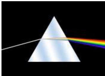
Рис. 3.11. Розкладання білого світла трикутною призмою; утворення спектральної смуги
