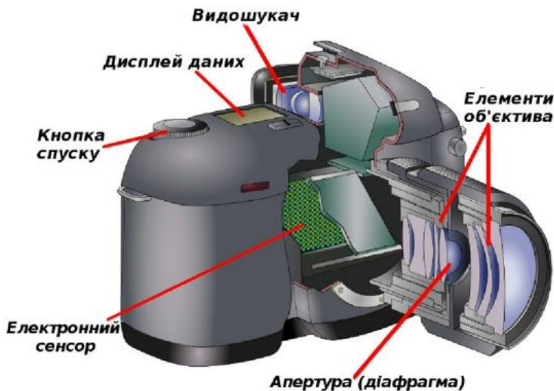
Рис. 3 Будова цифрового фотоапарата
