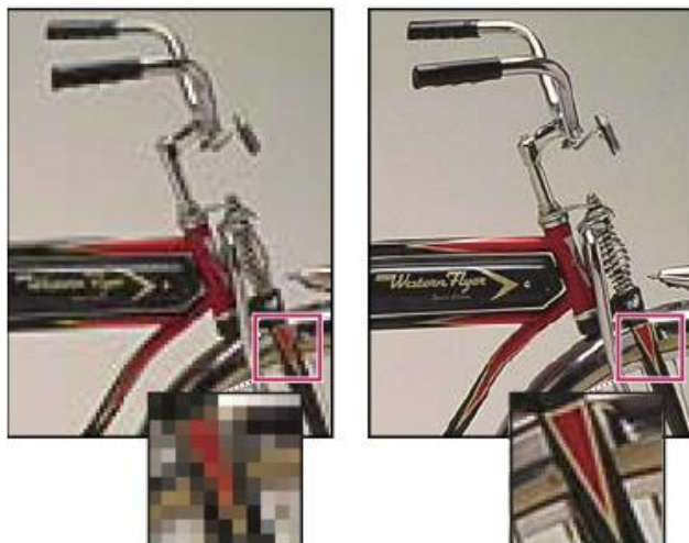
Рис.5 Одне і те ж зображення при роздільній здатності 72-ppi і 300-ppi; збільшено до 200%
