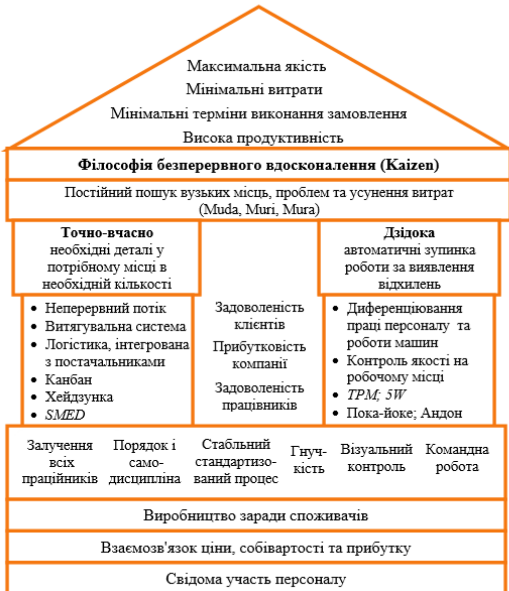
Рис. 1.2. Схеми виробничої системи компанії «Тойота»
