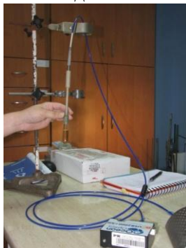
Фото. 2.2. Процес вимірювання спектральних характеристик барвника на спектрофотометрі “Oceanoptics” USB 2000 +XR
