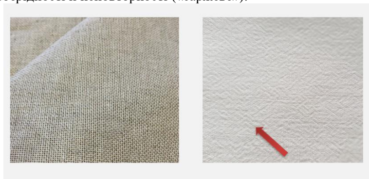
Рис. 2 Саржеве (зигзагоподібне)переплетення ниток полотна
