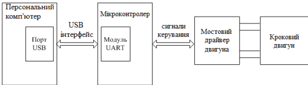
Рис. 1. Структурна схема СУ кроковим двигуном на базі мостового драйвера
