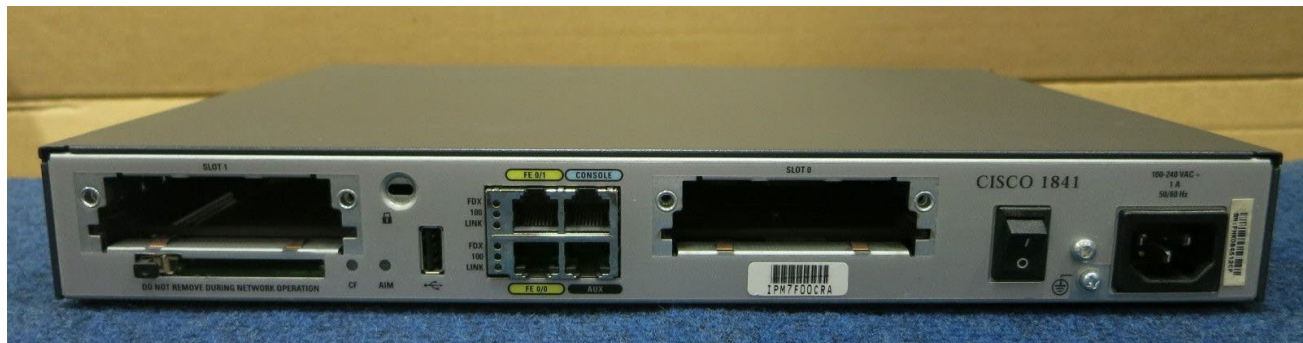
Рис. 1.1. Елементи задньої панелі маршрутизатора Cisco 1841
