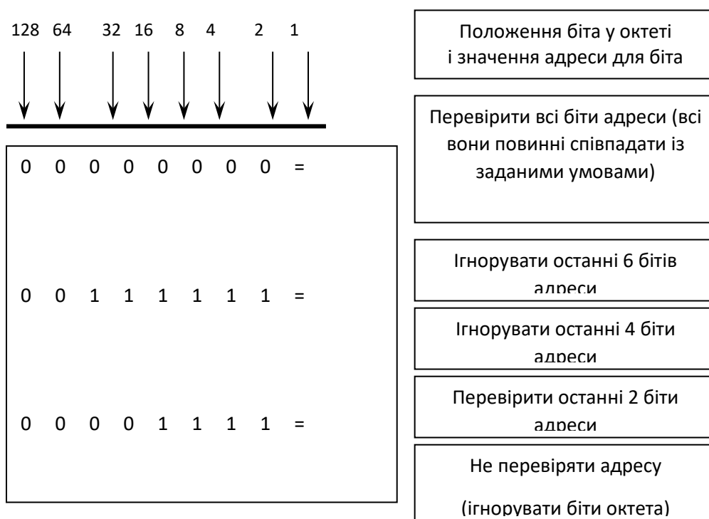
Рис. 8.1. Використання шаблону маски для обрання одного або декількох IP-адрес для виконання перевірки на дозвіл доступу або відмову в доступі
