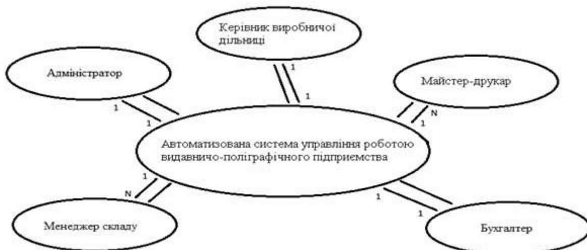
Рис. 1. Концептуальна модель автоматизованої системи управління роботою видавничо-поліграфічного підприємства (АСУ ВПП).
