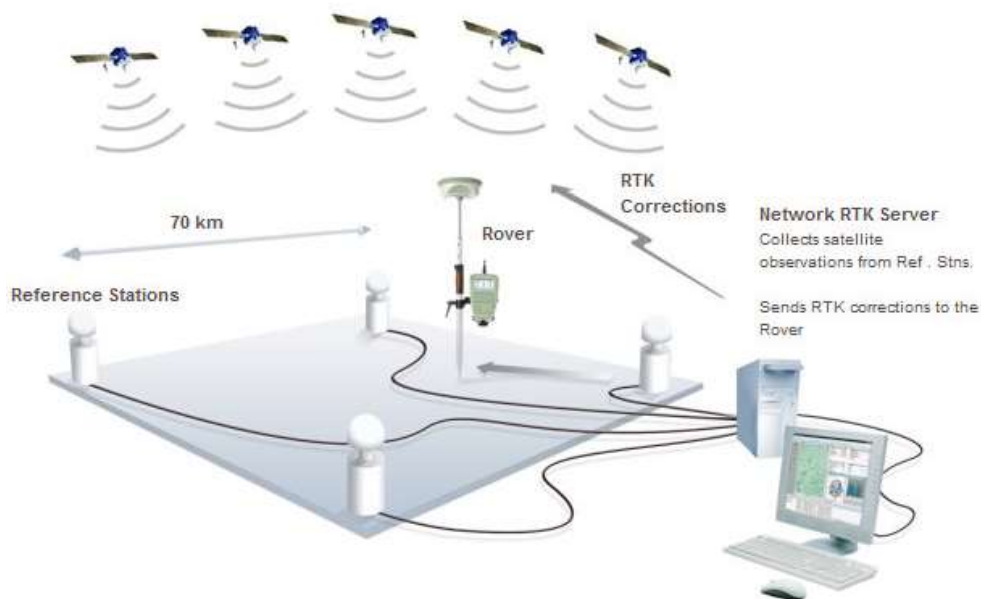
Рис. 3.13. Схема отримання координат в RTK-режимі
