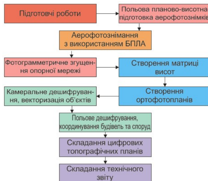
Рис. 3.10. Технологічна схема виконання аерофотознімання із БПЛА
