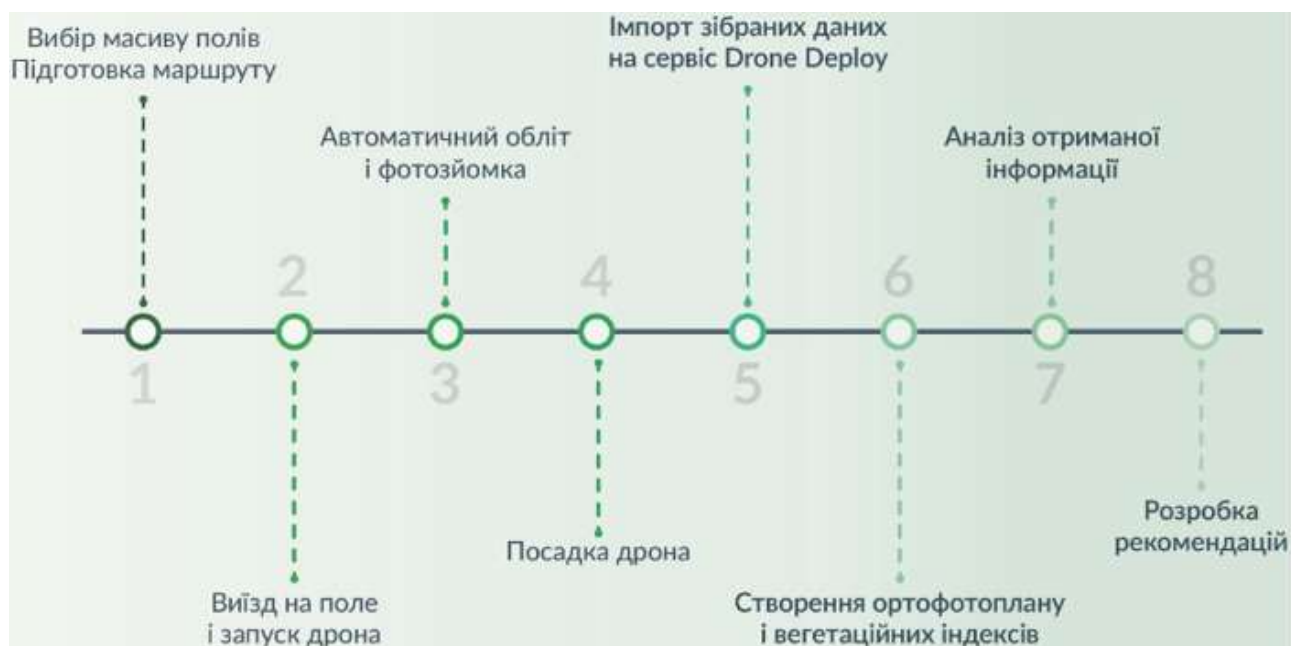
Рис. 3.15. Етапи моніторингу посіви за допомогою дрона
