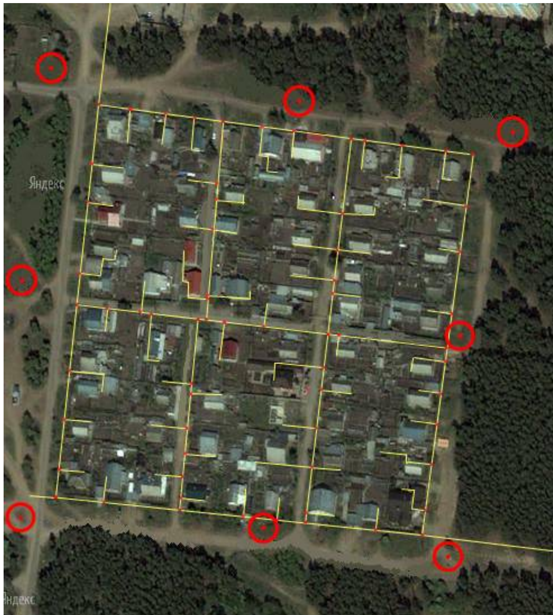
Рис. 3.20. Проект виносу в натуру характерних точок підземних комунікацій із прив'язкою до опорних пунктів
