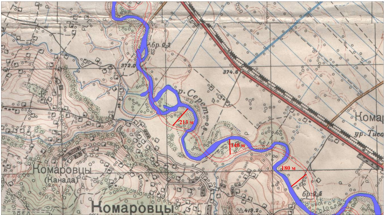
Рис. 3.27 Горизонтальні зміщення русла річки Сірет поблизу с. Комарівці оцифровані по топографічній карті 1957 р. (синій колір) масштабу 1:25 000 та по знімку 2016 р. (червоні межі).
