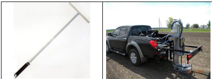
Рис. 2.3. Обладнання для відбору проб ґрунту (а – бур; б – автоматичний пробовідбірник).
