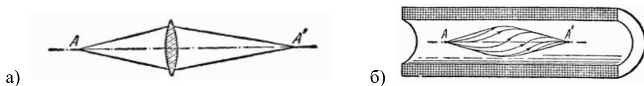
Рис. 2. Схема розповсюдження електромагнітної хвилі у лінзах а) оптичного та б) електронного діапазонів
