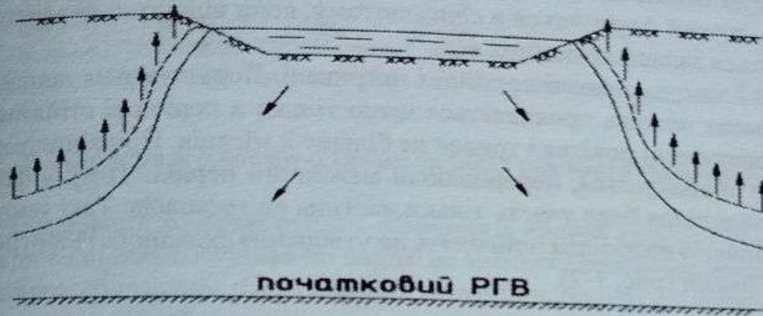
Рис. 2. Схема підпертої фільтрації
