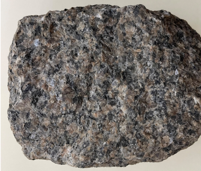
Рис. 26. Граніт. Структура рівномірно-середньозерниста, текстура масивна
