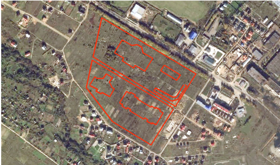
Рис. 3.16. Накладання векторизованих елементів генплану на космоснімок
