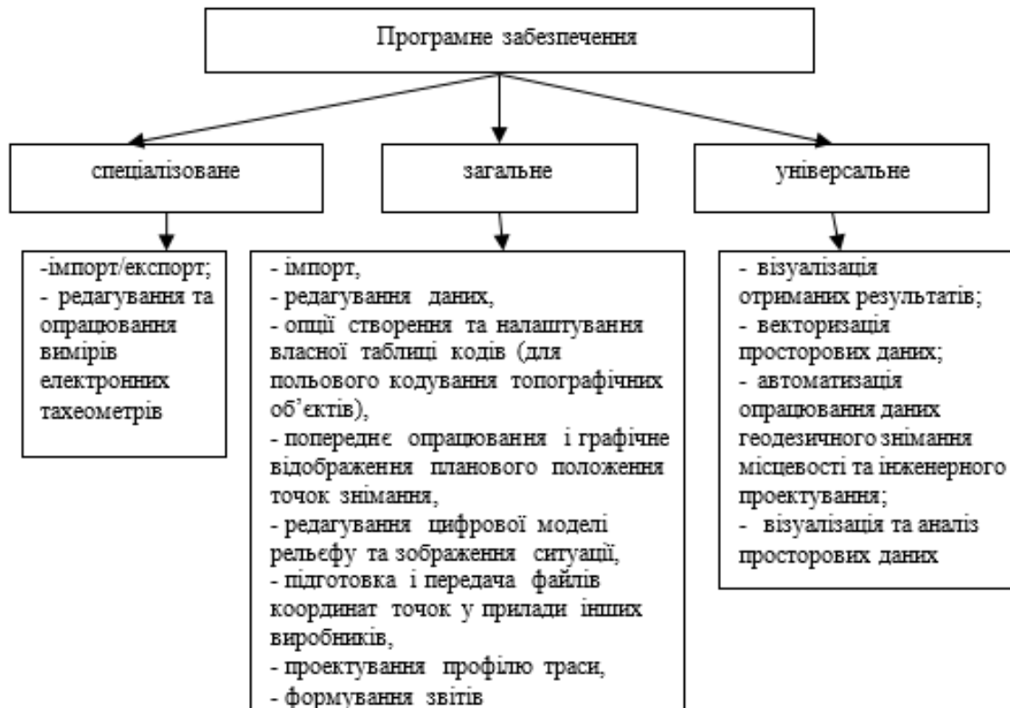
Рис. 2.3. Різновиди програмного забезпечення в геодезії
