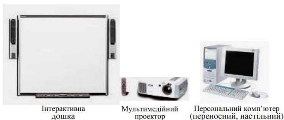
Рис. 1.1. Склад апаратної частини комплексу SMART Board
