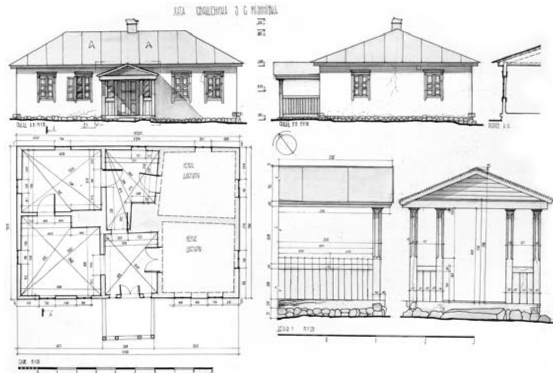
Рис. 10.16. Хата з с. Мізинівка, Черкаської обл., поч. XX ст. а. Кроки обмірів. б. Фасади, план першого поверху та деталі елементів входу. Кафедра АПЦБС КНУБА. Студент 1 курсу О. Гребенюк. Керівники: асистенти Т.І. Грінченко, Д.В. Отрошенко, М.Ю. Откаленко, 2014.
