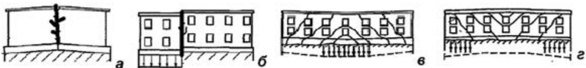
Рис. 8.3. Типи деформації споруд внаслідок нерівномірного осідання:
